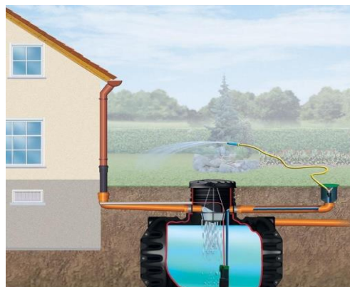
Figure 2 : Récupérateur d'eau de pluie enterré
