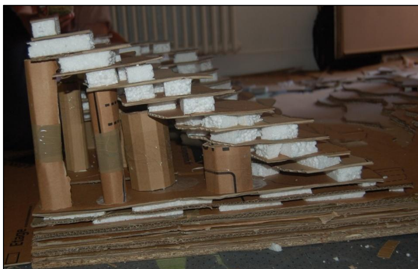
Méthode des « pilotis » pour diminuer la quantité de cartons utilisés, et ainsi limiter les coûts tout en faisant des maquettes solides et légères
